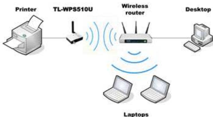
Беспроводной маршрутизатор является центром беспроводной сети, каждый из узлов соединяется с TL-WPS510U через беспроводной маршрутизатор. Локальная сеть: 192.168.1.0 (IP-адрес)/255.255.255.0 (маска подсети); IP-адрес TL-WPS510U должен быть таким: 192.168.1.10.
